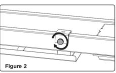
Drehen Sie die Schrauben fest um den Kabelhalter zu fixieren.
