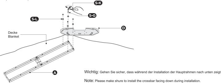
Befestigen Sie den zweiten Haupträger an der Verbindungsplatte mit 4 Schrauben und Unterlegscheiben.
